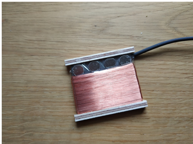
Alpen 4-String Single Coil mit hochpermeablem Silizium Kern
