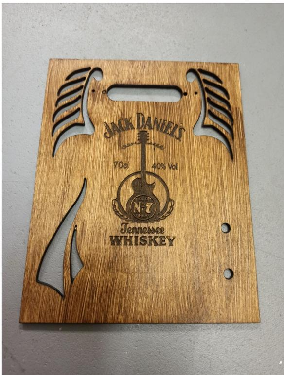
Vorbereiteter Deckel passend zu Camacho Zigarrenkiste mit Ausschnitt für Telecaster Pickup, Volumen und Tone Potentiometer und Soundlöcher
